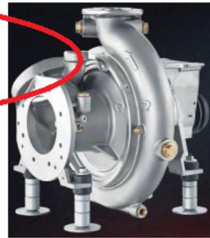
Se instalará una bomba centrífuga **MARCA ROSENBAUER N**. La bomba de panel lateral y montaje central tendrá una capacidad nominal de 1500 GPM- 5678 LPM y deberá cumplir con todas las secciones aplicables de las normas NFPA 1900, / DESALOJO NOMINAL DE 0 A 250 PSI, SE CONTEMPLA PISADERA DESLIZABLE BAJO MODULO BOMBA PARA UNA OPERACIÓN SEGURA
